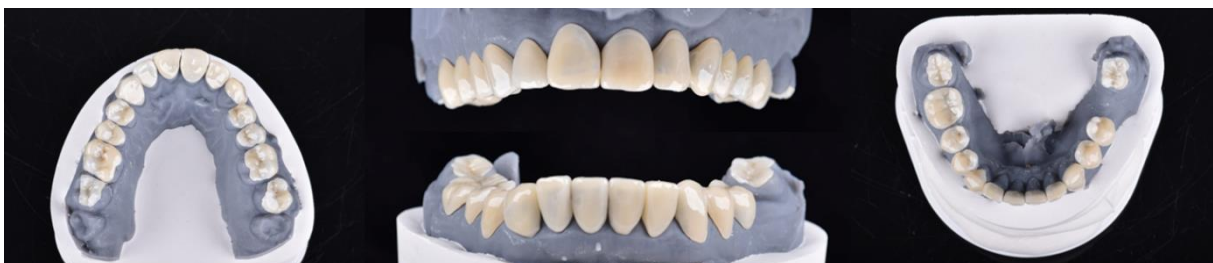
Abb. 5: Gedruckte Restaurationen: Verschiedene Restorationsgeometrien sind individuell druckbar.
